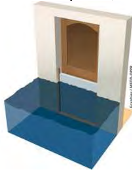
image : batardeau (MEDDE DGPR)
